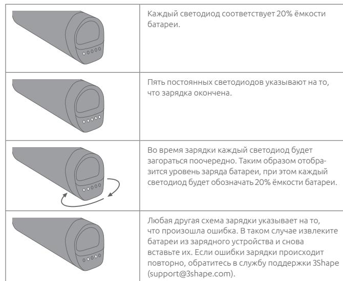
На нижней стороне зарядного устройства также имеется светодиодный индикатор. Светодиод отображает следующую информацию:
