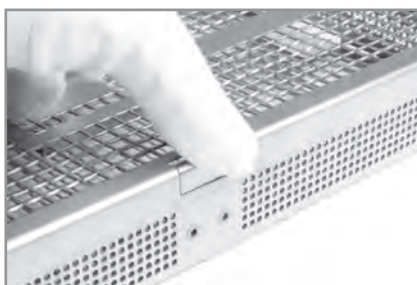
Drücken Sie den Druckverschluss nach innen und ziehen Sie den Deckel nach oben. Push the button inwards and pull up the top cover. Pressez le bouton à l'intérieur et soulevez le couvercle vers le haut.
